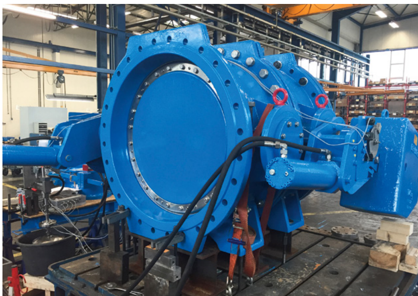
Druckprüfung bei der Abnahme im neuen ERHARD/TALIS-Logistikzentrum in Heidenheim (DE) Test de pression lors de l'approbation technique au nouveau centre de compétence ERHARD/TALIS à Heidenheim (DE)
