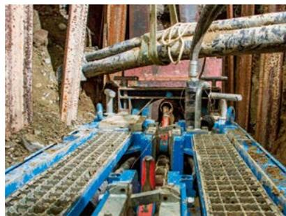
*Grundoburst-Maschine mit 80 t Zugkraft waren im Einsatz.*
